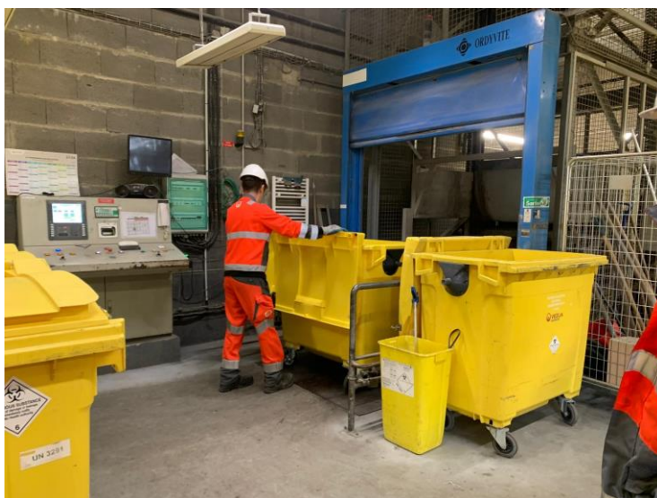
Figure 12 Chargement d'un conteneur dans le monte-charge pour incinération (Observation Usine d'incinération 29 février 2024)
